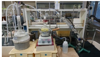
水蒸気蒸留装置
